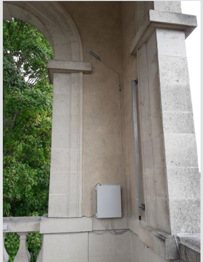
Exemple de réalisation comprenant des fissuromètres, un convergencemètre, un inclinomètre et une centrale d'acquisition multivoies autonome pour la surveillance d'un belvédère.
