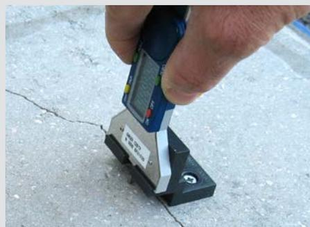
Mesure du rejet (avec montage de 2 supports)
