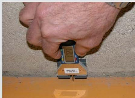
Mesure d'affaissement d'un plancher
