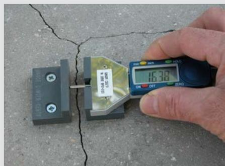
Mesure d'ouverture de fissure
