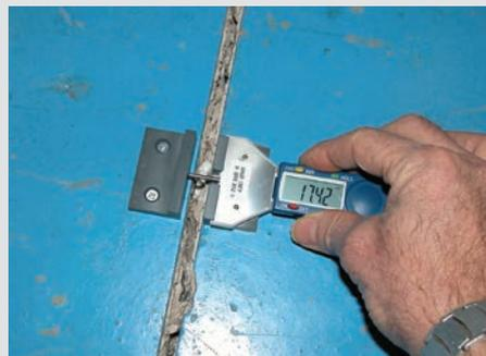
Mesure d'ouverture d'un joint de dilatation
