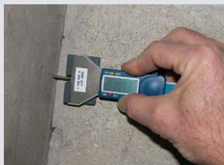
Mesure d'ouverture d'un angle de mur
